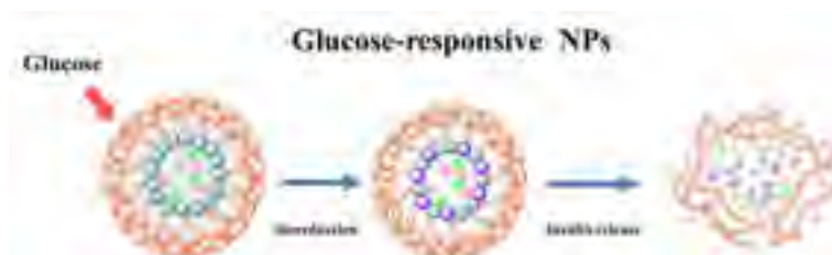
图 1 葡萄糖响应性纳米粒释药原理示意图
